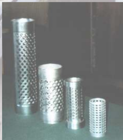
Детали с отверстиями, пробитыми эластичным инструментом
