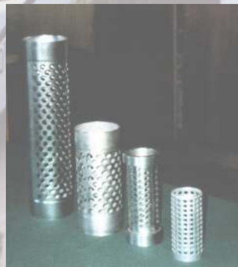
Детали с отверстиями, пробитыми эластичным инструментом
