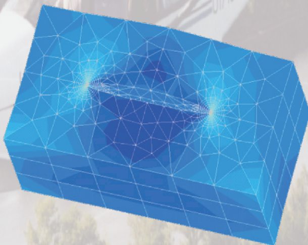
Конечно-элементная модель поверхностной трещины
