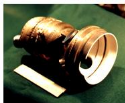
Труба жаровая двигателя НК-36СТ с теплозащитным покрытием.
