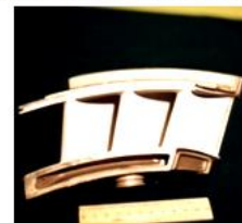
Блок соплового аппарата 1 ступени турбины двигателя НК-38СТ и НК-93 с теплозащитным покрытием (Ni-Co-Cr-Al-Y + ZrO_2/8Y_2O_3 + плазмодинамическое упрочнение).
