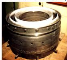
Камера сгорания ГТД с теплозащитным покрытием Ni-Co-Cr-Al-Y + ZrO_2/8Y_2O_3 и износостойким карбидным покрытием на наружной поверхности кольца.
