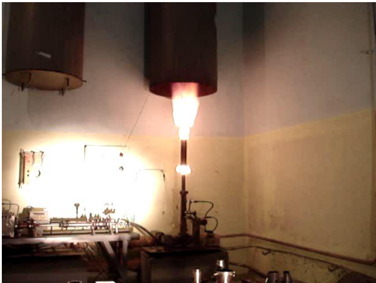
Рис. 5. Работающий макетный образец ПДД с эжекторным насадком
