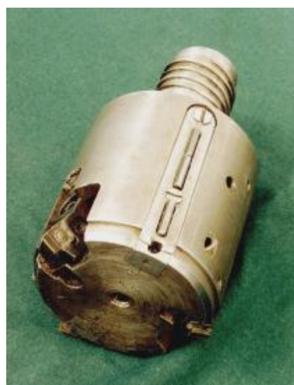
Рис.9. Общий вид двухрезцовой расточной головки
