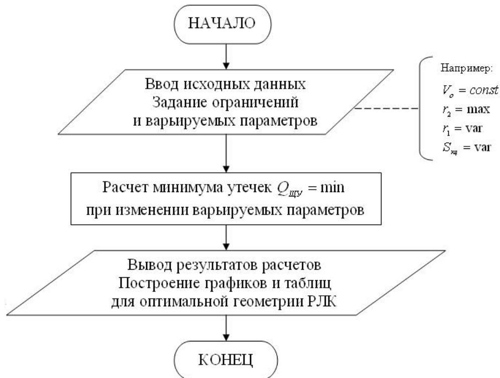
Рис. 2. Блок-схема алгоритма оптимизации геометрии роторно-лопастного компрессора
