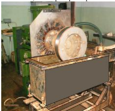
Рис.10. Фото установки для нанесения покрытий на посадочные поверхности крупногабаритных подшипников
