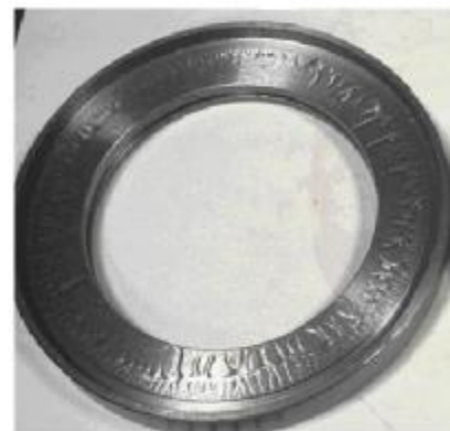
Рис.8. Устройство пластинчатого амортизатора и исполнение единичной пластины с нанесённым слоем олигодиметилсилоксановой жидкости
