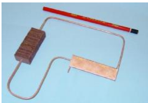
Рис. 8. Миниатюрная контурная тепловая труба Термическое сопротивление: 0,02-0,1 К/Вт
