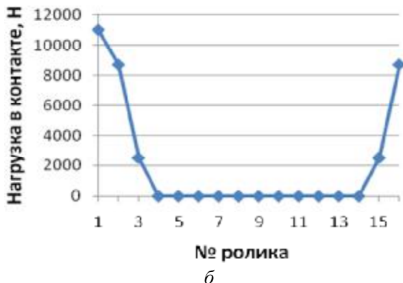
Рис. 6. Распределение нагрузки в контактах роликов с внутренним (а) и наружным (б) кольцами без учета деформаций сжатия внешнего кольца и частоты вращения водила
