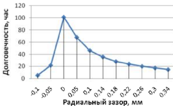
Рис. 8. Зависимость долговечности от радиального зазора в подшипнике
