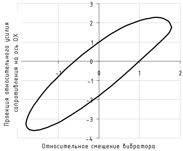
Рис.5. Зависимость относительной силы сопротивления демпфера в проекции на ось OX от амплитуды смещения вибратора в безразмерном виде
