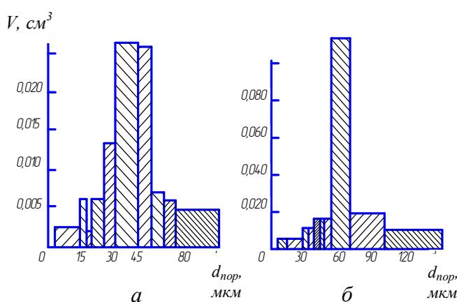
Рис. 1. Гистограммы зависимости объема пор от их размера: а -  $d_n = 90\text{мкм}$  и  $\Pi = 0,207$ ; б -  $d_n = 500\text{мкм}$  и  $\Pi = 0,398$
