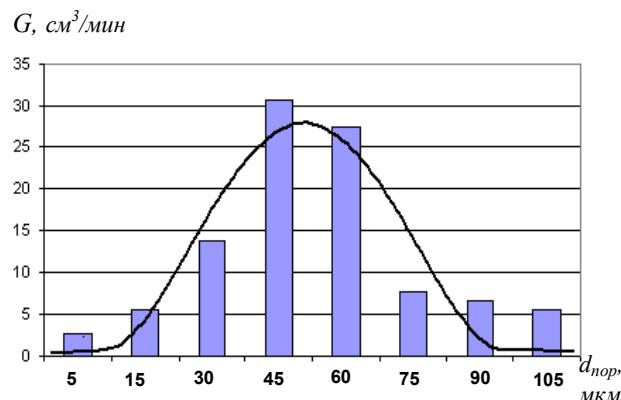
Рис. 2. Распределение расхода жидкости в порах образца (а), выполненного из материала МР в начальный момент времени
