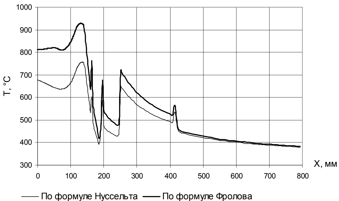
Рис. 2. Распределение температуры стенки со стороны газа
