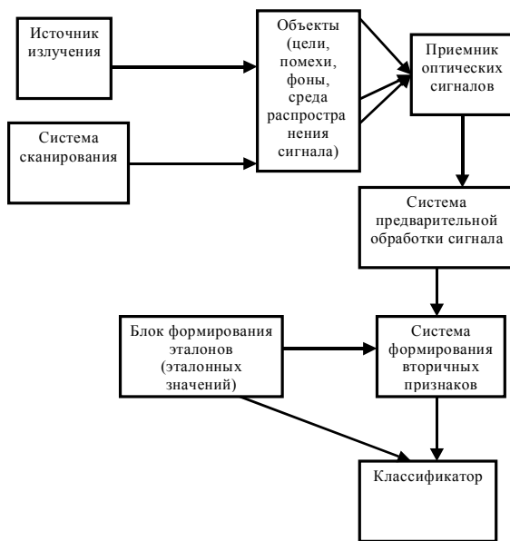
Рис. 1. Структурная схема лазерно-электронной системы дистанционного зондирования поверхности
