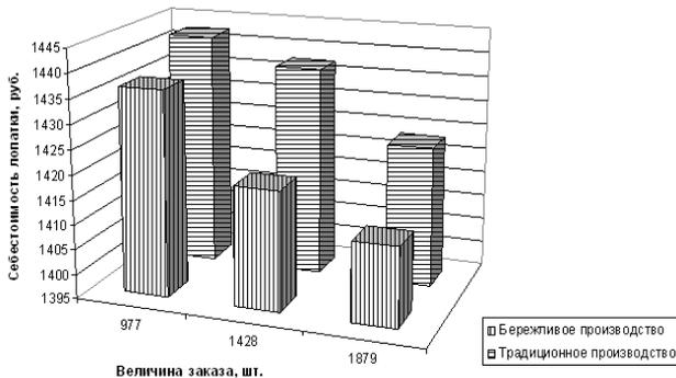
Рис. 1. Сравнительная себестоимость лопатки при традиционном и бережливом производствах, руб
