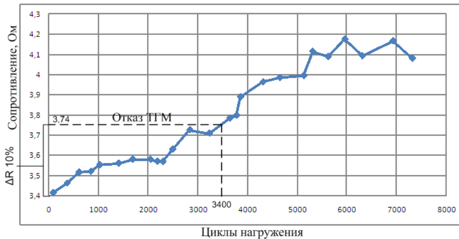
Рис. 7. Изменение сопротивления при циклическом нагружении ТГМ
