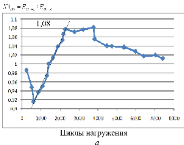
Рис. 6. Изменение информативных параметров АЭ при циклическом нагружении ТГМ: X1_{aэ} = E_{35-42} / E_{30-35} (а); X2_{aэ} = E_{38-48} / E_{30-35} (б)
