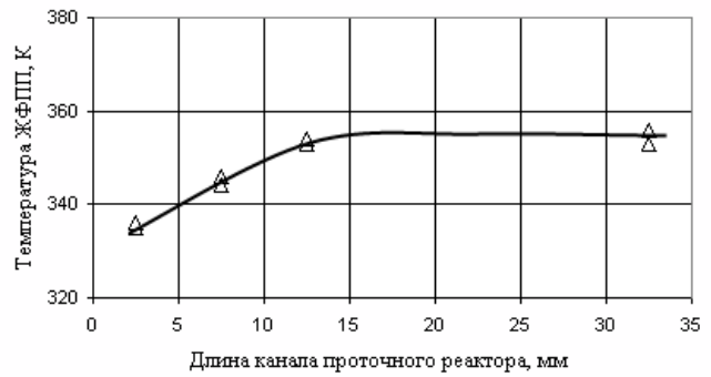
Рис. 6. Зависимость температуры ЖФПП от длины канала проточного реактора
