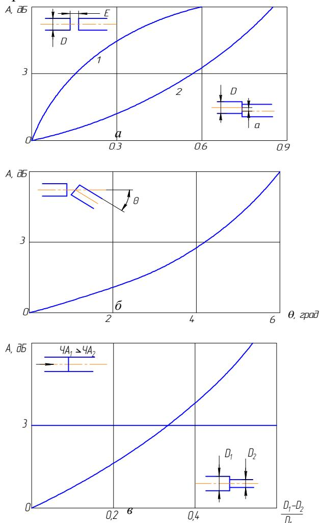
Рис.1. Экспериментальные зависимости величины ослабления сигнала при согласовании волокон от зазора ( $a$ , зависимость 1), осевого рассогласования ( $a$ , зависимость 2), углового смещения ( $\theta$ ) и разности числовых апертур ( $\delta$ )
