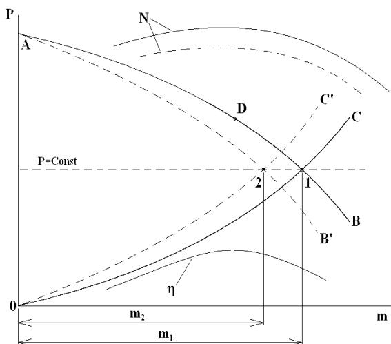
Рис 1. Характеристики компрессора и сети при  $P_k=Const$
