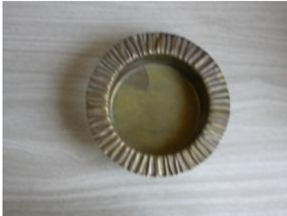
Потеря устойчивости фланца заготовки при недостаточной силе прижима а)
