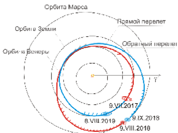
Рис. 2.21. Оптимальная баллистическая схема экспедиции Земля-Марс-Земля
