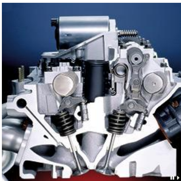
Рис. 5. Реализация системы VALVETRONIC
